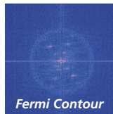
極低温・強磁場環境における Au(111) 表面の原子分解能 STM 像と微分コンダクタンス像ならびに FFT 処理によるフェルミ面のイメージング。 Atomic resolution STM imaging of Au(111) at 0.6K and its dI/dV imaging in 6T with a 2D-FFT Fermi contour image.
